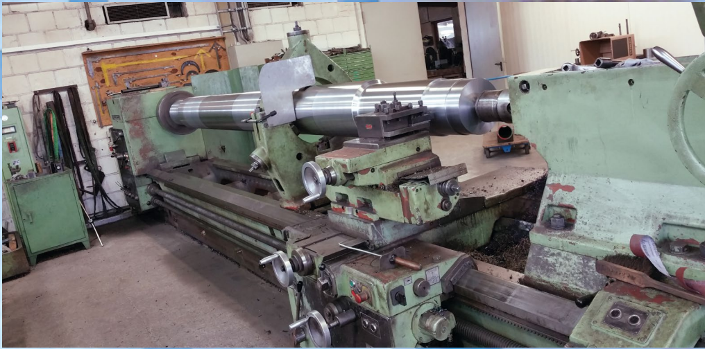
Wasserrad-Welle beim Drehen
